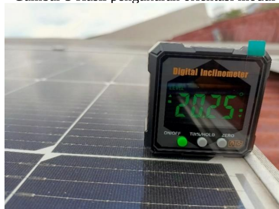
Gambar 4 hasil pengukuran sudut kemiringan modul
