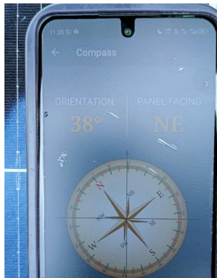
Gambar 3 Hasil pengukuran orientasi modul
