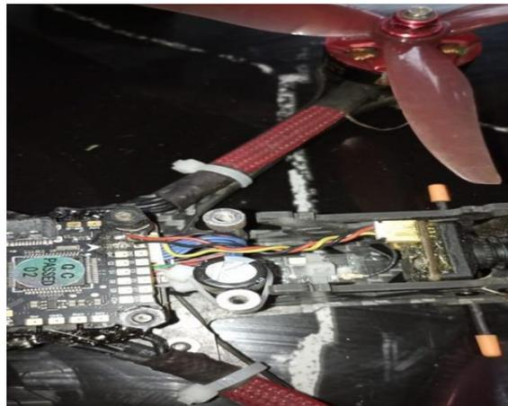
Gambar 7 Pemasangan Kabel Kamera Ke Pin out FC
