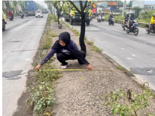
Gambar 1 Pengukuran Geometrik Jalan
