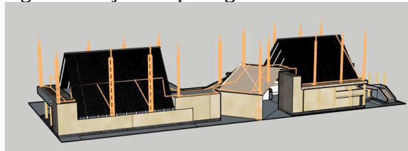
Gambar 14 Model Tampak Samping Saluran pembumian Metode Bola Bergulir
