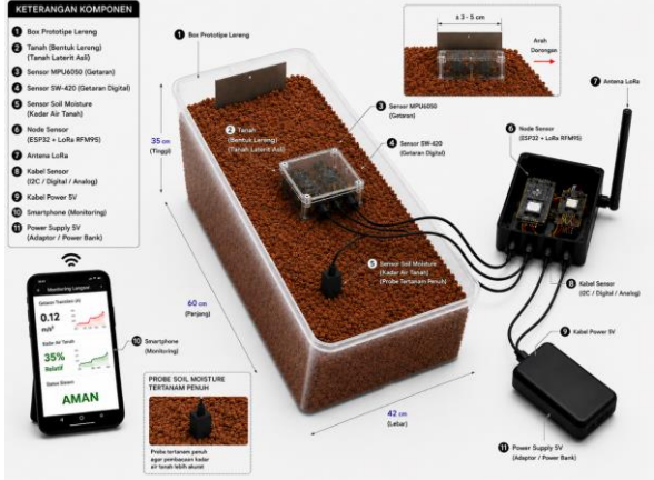
Gambar 4. Tata letak sensor pada prototipe lereng tanah.
