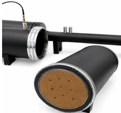
Gambar 26 Pengujian Akustik Spesimen Tidak Berlubang
