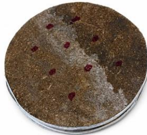
Gambar 35 Sample Pengujian Akustik Tidak Berlubang
