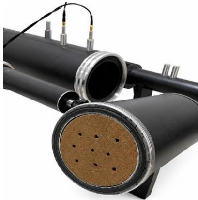
Gambar 27 Pengujian Akustik Spesimen 3/9
