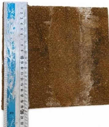
Gambar 23 Pengukuran Panjang dan Lebar Sadake Board
