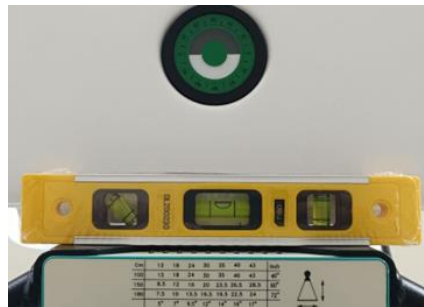
Gambar 6. Pengukuran kesejajaran tabung sinar-x mobile
