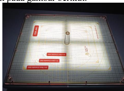
Gambar 8. Pengaturan tepi lapangan cahaya.
