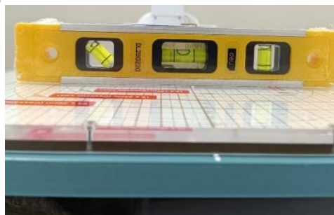
Gambar 4. Pengukuran kesejajaran IR meja mobile
