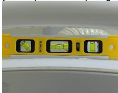
Gambar 7. Pengukuran kesejajaran tabung sinar-x stasioner
