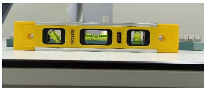
Gambar 5. Pengukuran kesejajaran IR meja stasioner
