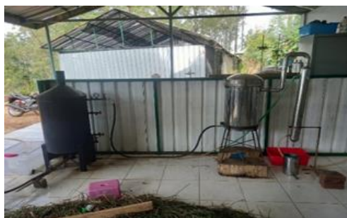
Gambar 1 Rangkaian Alat Proses Destilasi Metode Uap (Sumber: Dokumentasi Pribadi) Isolasi minyak atsiri daun cengkeh ( Syzygium aromaticum L.) yang dihasilkan berwarna kuning bening sedikit kehijauan dan memiliki aroma khas daun cengkeh. Minyak atsiri daun cengkeh ini memperoleh rendemen seperti pada tabel 1.
