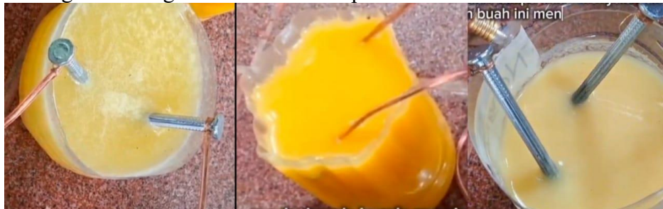
Gambar 1. Uji elektrolit ekstrak buah : (a) Nanas, (b) Jeruk Manis dan (c) Nangka
