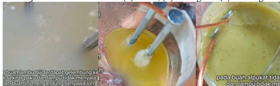
Gambar 3. Uji elektrolit ekstrak buah: (a) Jambu biji, (b) Belimbing Wuluh dan (c) Alpukat
