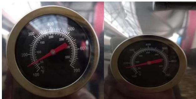
Gambar 2. Temperatur uap dari mini boiler
