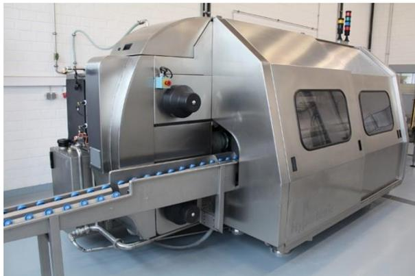
Gambar 1. Mesin High Pressure Processing (HPP) untuk sterilisasi tanpa panas (Sumber: FOX, n.d.)
