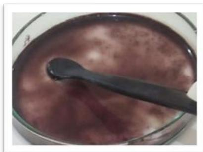
Gambar 6 Endapan ditambahkan dengan H<sub>2</sub>O<sub>2</sub> 30%, terjadi letupan dan berubah menjadi larutan kecoklatan.
