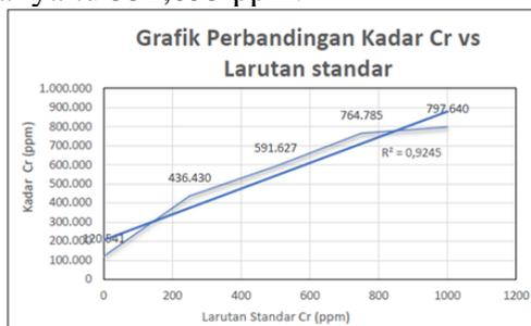
Gambar 1 Kurva kandungan Cr dalam larutan standar dengan analisis XRF
