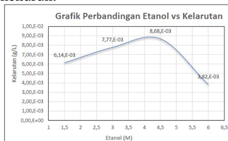
Gambar 4 Kelarutan endapan Cr(OH)<sub>3</sub> dalam air limbah setelah iradiasi
