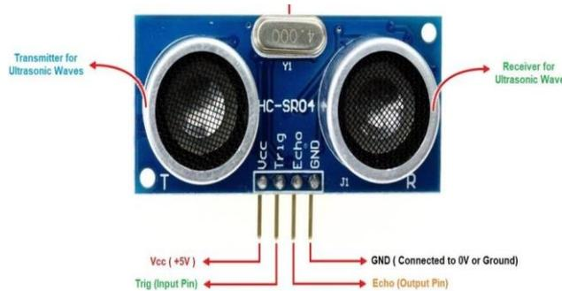
Gambar 3 Rangkaian Sensor Ultrasonik
