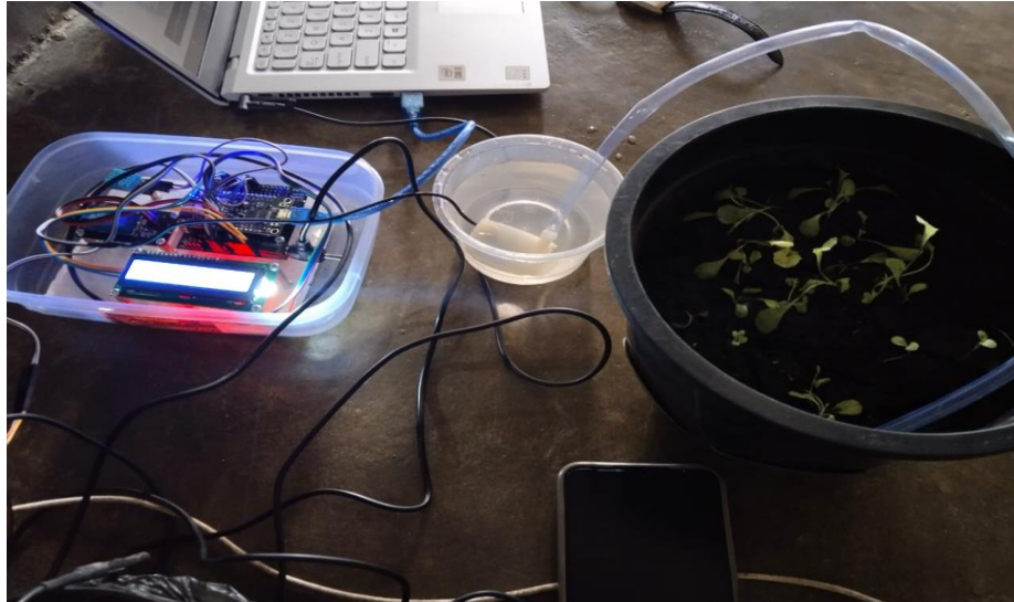
Gambar 5. Sistem penyiraman otomatis pada tanaman
