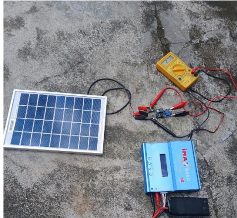
Gambar 6. Pengisian baterai dengan solar panel Sumber: Dokumentasi Penulis, 2024
