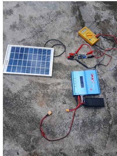
Gambar 13. Pengukuran Tegangan Sollar Cell dengan Beban
