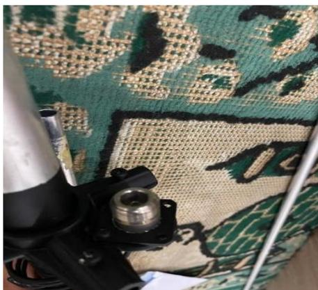
Gambar 3 Konektor Input Antena
