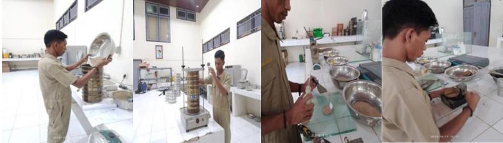
Gambar 2 Proses pengujian analisis saringan terhadap tanah lempung, serbuk kaca dan atterberg limit
