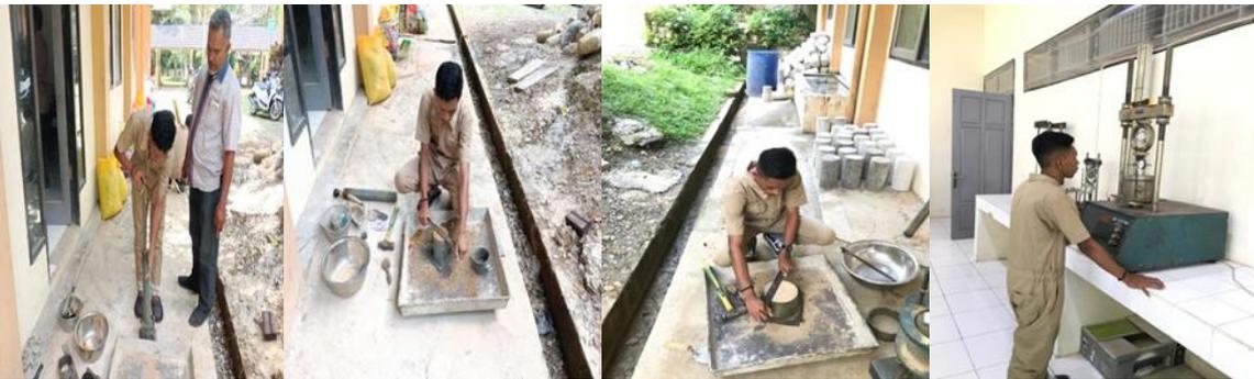
Gambar 3 Proses pengujian kepadatan tanah dan Uji CBR
