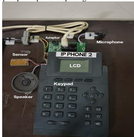
Gambar 5. Hasil Instalasi Pesawat Telepon Sumber: Dokumentasi Penulis, 2024
