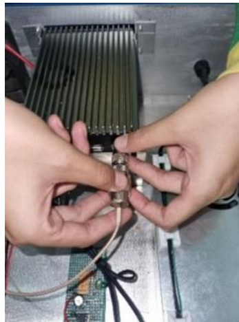
Gambar 2 Penyambungan Pemancar Pada Palet Booster dan Input Audio
