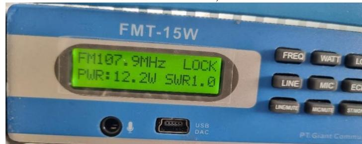
Gambar 8 Indikator Display Pemancar Menggunakan Dummy Load
