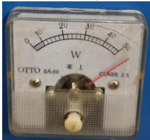
Gambar 7 Indikator Output Daya Pemancar Menggunakan Antena
