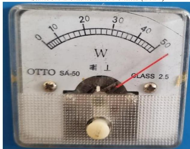
Gambar 9 Indikator Output Daya Pemancar Menggunakan Dummy Load
