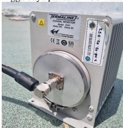
Gambar 5 Penyambungan Kabel Output RF Amplifier ke Dummy Load
