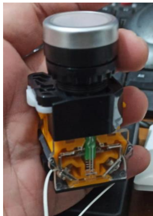
Gambar 7 Push Button mengaktifkan kembali sensor
