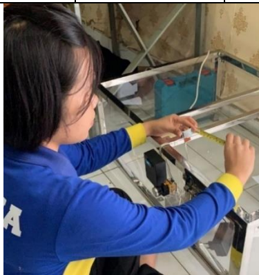
Gambar 14 Pengujian sensor PIR 10-50 cm
