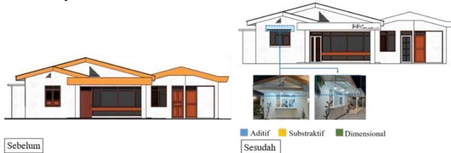
Gambar 13. Elemen Sun shading pada Kafe Teras Rumah Café
