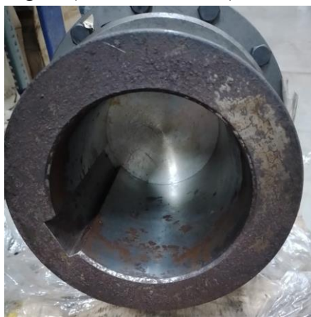
Gambar 1. Dampak Terjadinya Korosi Pada Material Baja Carbon Lantai Dasar
